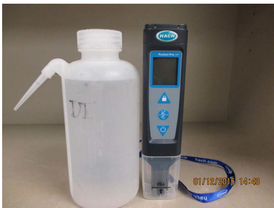
2 - DI Rinse Bottle (Electrode Maintenance)
