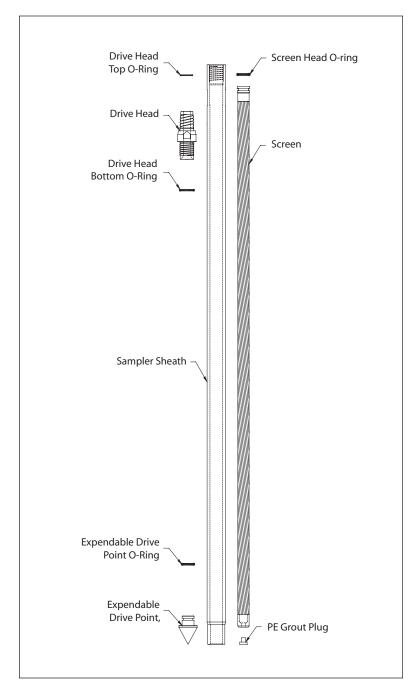
**GEOPROBE® SCREEN POINT 16 GROUNDWATER SAMPLER PARTS**
